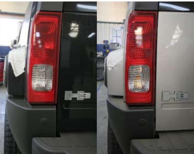
Achteruitrijlicht wordt richtingaanwijzer. Samen met nog een aantal andere aanpassingen besteedt Broekman Automotive dertien uur aan het aanpassen van een Hummer voor de Europese markt.
