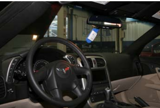
'Ach, één Corvetje mis je toch niet?', vroegen wij hoopvol. Helaas, elke auto heeft een RFID-verklikker (op de foto in blauw-wit) die vertelt waar de auto zich op de meter precies bevindt.
